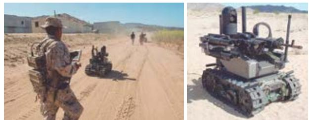
El robot MAARS puede armarse con una ametralladora M240B de 400 rondas, un lanzagranadas o incluso usarse para sacar a los soldados heridos del peligro. Capaz de alcanzar una velocidad máxima de solo 7 mph, es lo suficientemente rápido como para mantenerse al día con las tropas y también tiene el poder de permanencia, con un sistema de batería capaz de funcionar hasta 12 horas.
